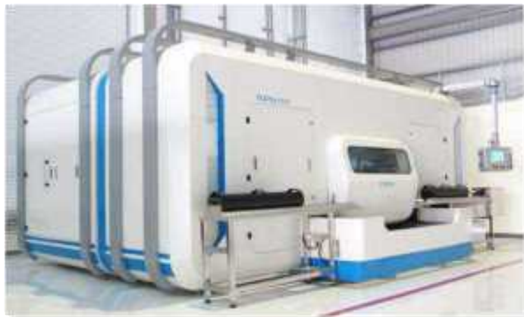
達璞 HPP 設備
